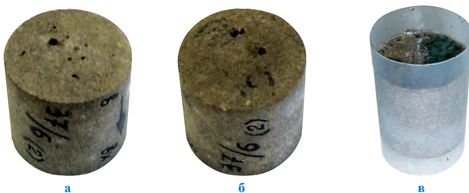
Рис. 3. Вид образца по окончании закачки 0,5 объема пор кислотной эмульсии на углеводородной основе: а – входной торец; б – выходной торец; в – вид образца с оставшимися фрагментами фильтрационной корки
