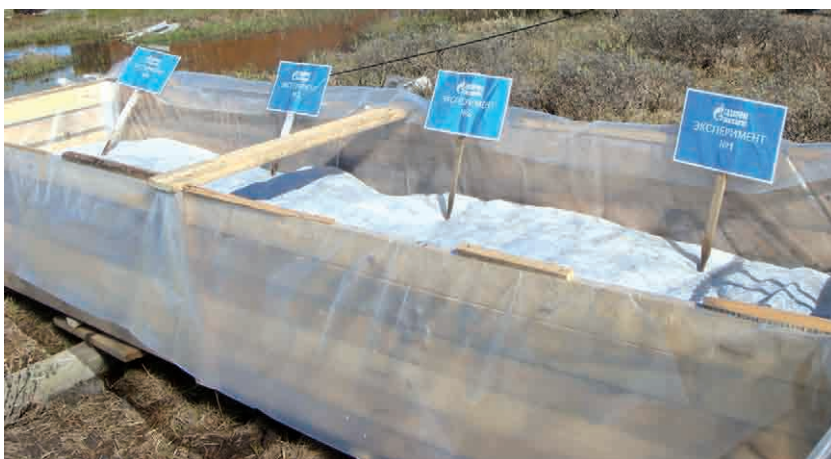
Рис. 3. Очистка в твердофазном ферментере
