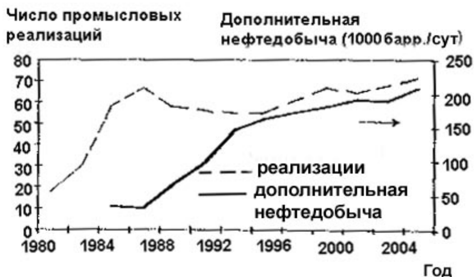
Рис. 5. Количество проектов увеличения нефтеотдачи пластов методом нагнетания диоксида углерода и дополнительно добываемая при этом нефть (1 барр. = 158,988 дм 3 ) в 1980–2004 гг. в США
