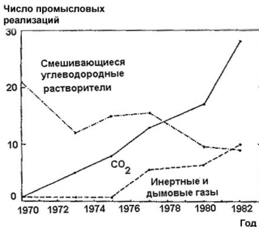
Рис. 4. Количество проектов увеличения нефтеотдачи пластов методом нагнетания различных веществ в 1970–1982 гг. в США
