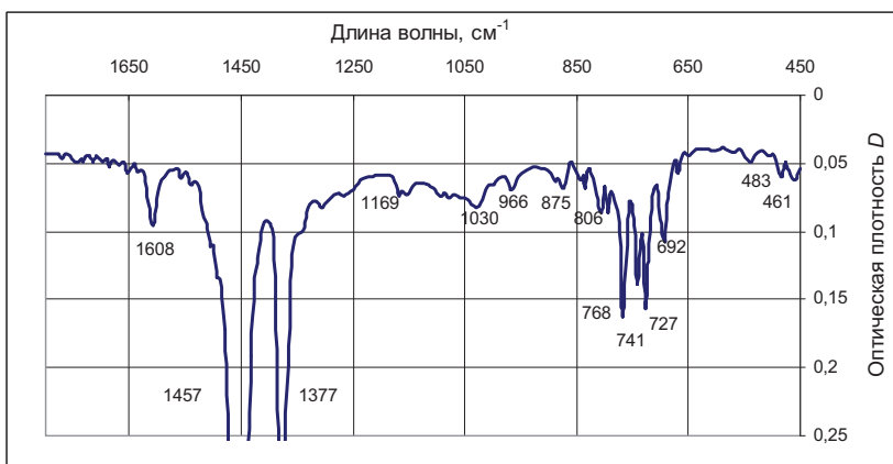
Рис. 5. Типичный ИК-спектр конденсатов Уренгойского НГКМ (метаново-нафтеновый тип)
