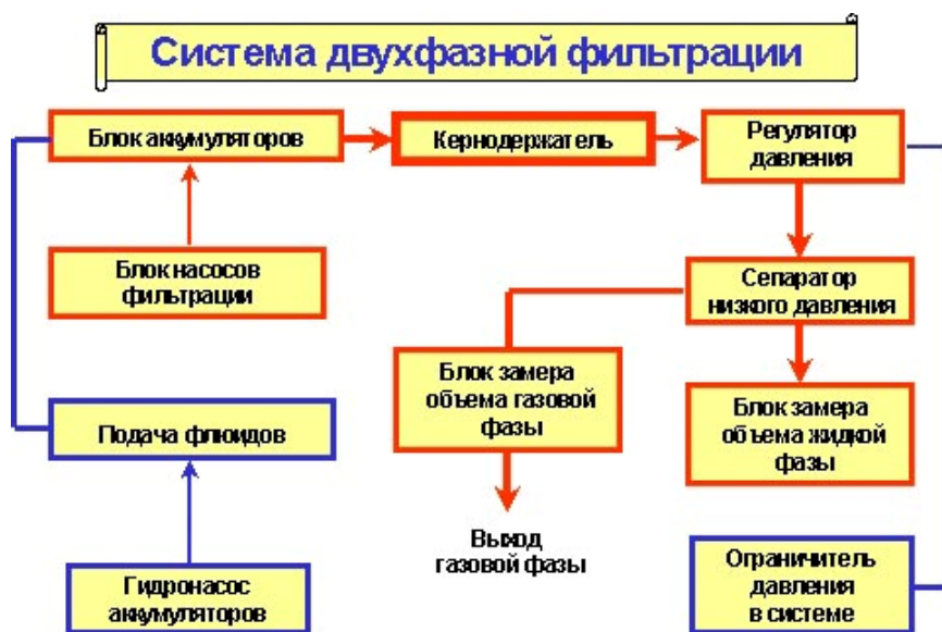
Рис. 1. Функциональная блок-схема экспериментальной установки двухфазной фильтрации
